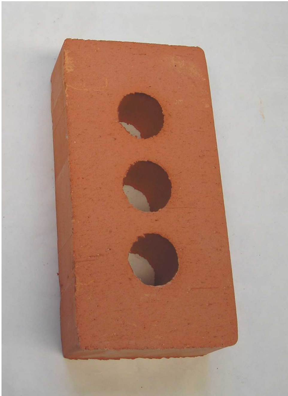
Figura 1. Riproduzione fotografica di un provino tal quale del prodotto “ Mattone Faccia a Vista 3 Fori Gaiole, 24x12x5.5 ”.
